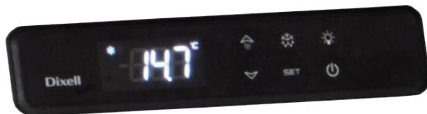
Термостат запрограммирован, поэтому нет необходимости в его настройке. При включении стола, на экране дисплея появится актуальная внутренняя температура стола.
