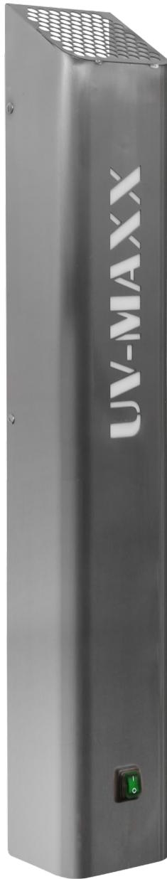
Рециркулятор относится к закрытым бактерицидным облучателям и предназначен для обеззараживания воздушной среды в помещении, исполнение HEAVY DUTY, корпус выполнен из нержавеющей стали. Обеззараживание воздуха происходит путём его прохождения через закрытую камеру, внутренний объем которой облучается излучением бактерицидных ламп.
