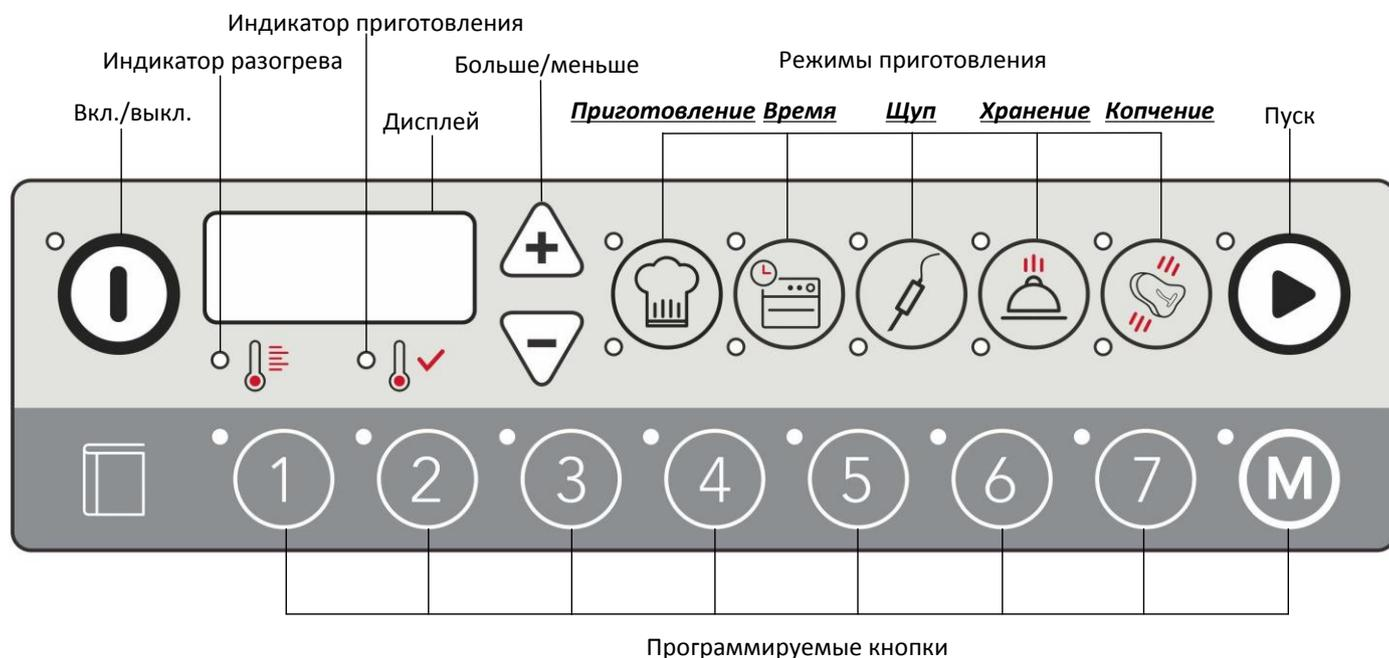
Рис. 3. Панель управления печи ISTOMA-EM
