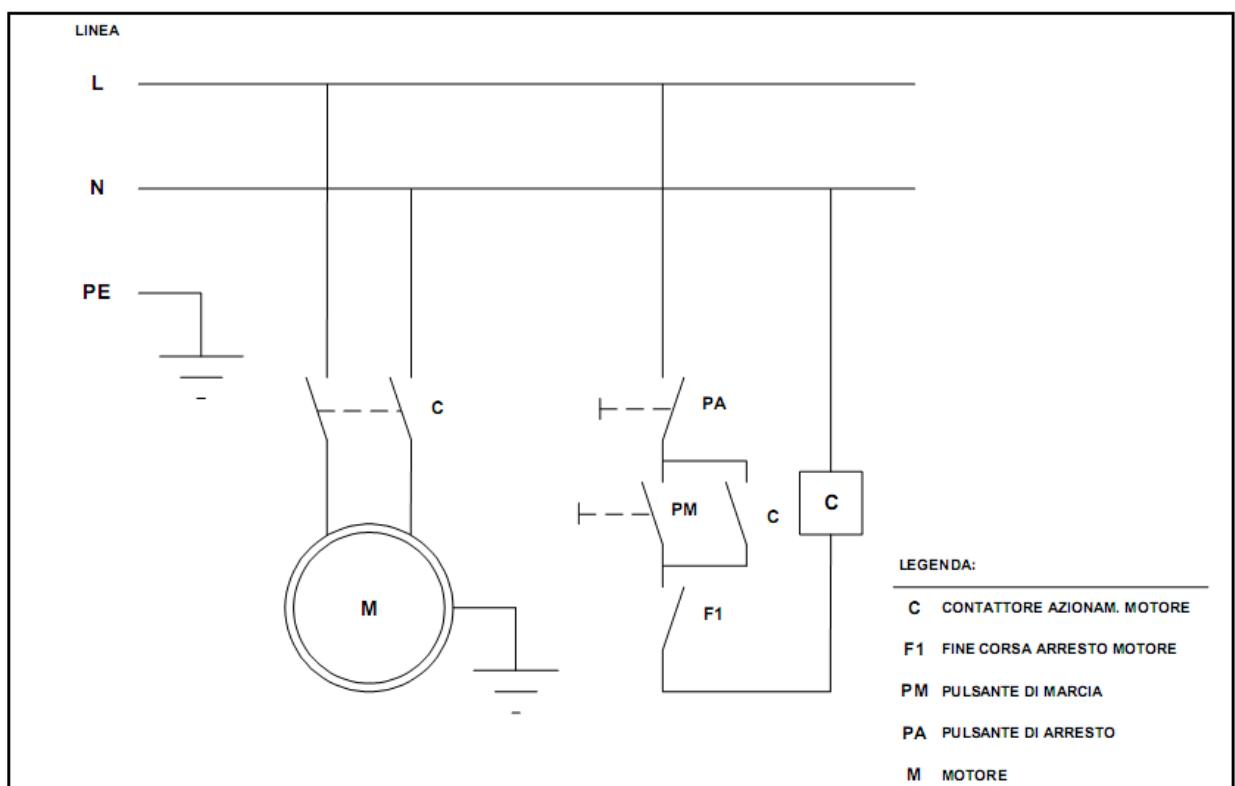
Электрическая схема тестомеса с трехфазным двигателем
